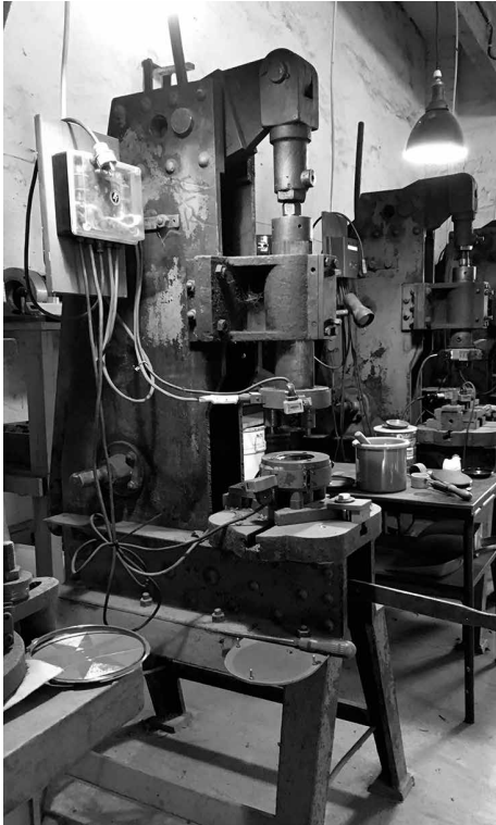
Bakelit-Pressen im Bakelitmuseum Kierspe. Das Bakelitgranulat wurde durch Druck und Hitze in einer Metallform zum Schmelzen gebracht. Dieser Vorgang dauerte je nach Werkstück einige Minuten. Ein Bakelitpresser bediente mehrere Pressen gleichzeitig. Er befüllte fortlaufend die Formen und entnahm die fertigen Werkstücke. Silvia Baukloh, Heimatverein Kierspe
